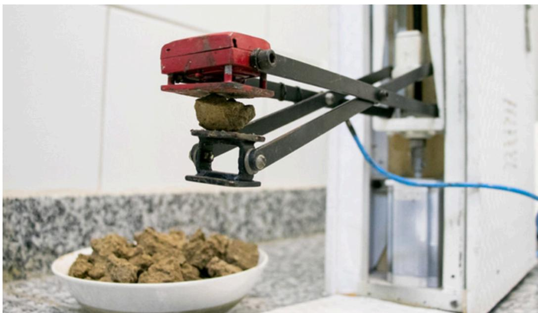
Equipamento patenteado pelo professor Jaedson Mota permite a análise física do solo diretamente no campo
